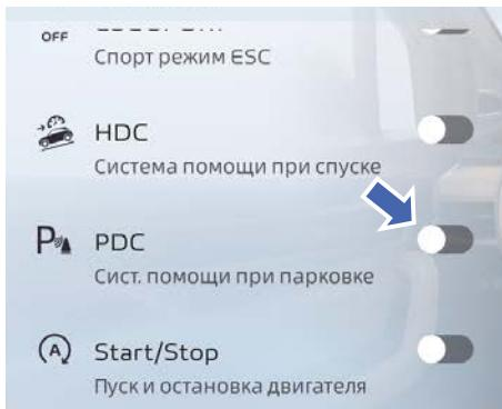
После запуска двигателя система помощи при парковке включается автоматически. Если необходимо отключить систему, нажмите на мультимедийном дисплее: Общие настройки автомобиля → Настройки автомобиля → Системы помощи при вождении, а затем выключите систему помощи при парковке в этом интерфейсе.
