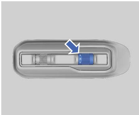
Поверните регулятор света фар, чтобы изменить угол наклона светового пучка фар в зависимости от количества пассажиров и загрузки автомобиля.
