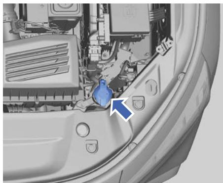
Чтобы добавить омывающую жидкость, откройте крышку заливной горловины с символом стеклоомывателя и долейте омывающую жидкость в необходимом количестве.
