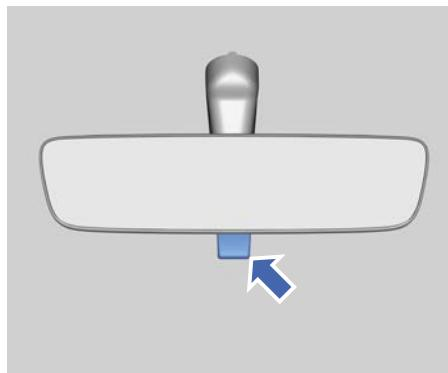
Нажмите рычажок в нижней части корпуса внутреннего зеркала заднего вида, чтобы изменить угол обзора и активировать режим затемнения; потяните рычажок назад, чтобы вернуть внутреннее зеркало заднего вида в нормальное положение и отключить режим затемнения.
