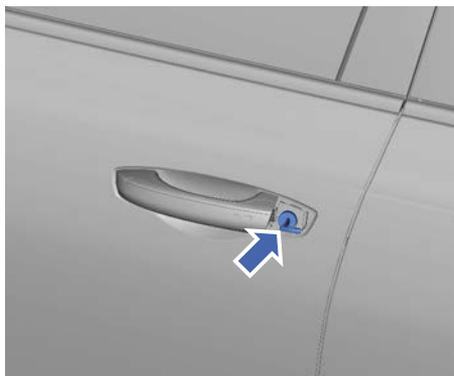
3. Вставьте механический ключ в скважину замка на водительской двери. Поверните ключ против часовой стрелки для запирания двери. Поверните ключ по часовой стрелке для отпирания двери.
