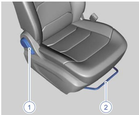
1. Ручка регулировки наклона спинки
