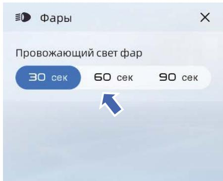
На мультимедийном дисплее нажмите: Общие настройки автомобиля → Настройки автомобиля → Фары, а затем выберите время задержки выключения света фар в интерфейсе настройки данной функции. Когда функция задержки выключения света фар активирована, таймер устанавливается на предварительно заданное время. Если открыть любую дверь (включая дверь багажного отделения) до истечения таймера, таймер будет сброшен на предварительно заданное время.
