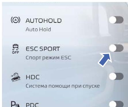
После запуска двигателя нажмите на мультимедийном дисплее Общие настройки автомобиля → Настройки автомобиля → Системы помощи при вождении, чтобы активировать «Спорт режим ESC». При включении переключателя «Спорт режим ESC» система ESC автоматически отключается. **⚠** На комбинации приборов загорится индикатор отключения электронной системы курсовой устойчивости, и отобразится сообщение: «Система ESC отключена».
