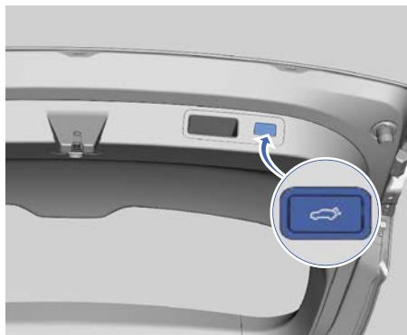
Когда автомобиль неподвижен и дверь багажного отделения открыта, нажмите кнопку закрывания двери багажного отделения, чтобы закрыть багажное отделение.
