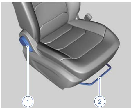
1. Ручка регулировки наклона спинки
