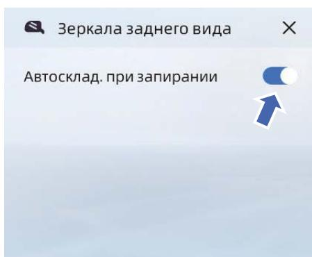
На мультимедийном дисплее нажмите: Общие настройки автомобиля → Настройки автомобиля → Зеркала заднего вида. Включите/выключите функцию складывания наружных зеркал заднего вида при запирании автомобиля в этом интерфейсе.
