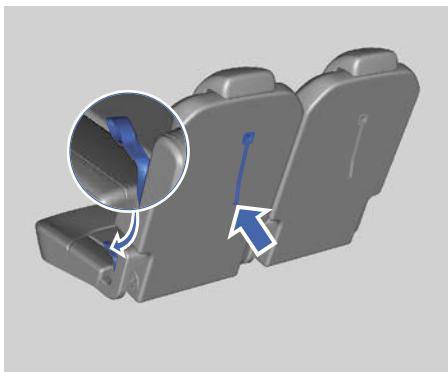
Потяните за ленты для складывания с обеих сторон подушки сиденья или спинки до упора, разблокируйте спинку заднего сиденья и наклоните ее в нужное положение, затем ослабьте натяжение ленты, и спинка заднего сиденья зафиксируется в новом положении.
