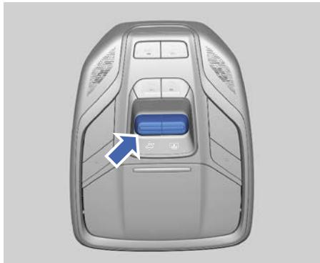
Переключатель верхнего люка находится на панели управления плафонами в передней части потолка.
