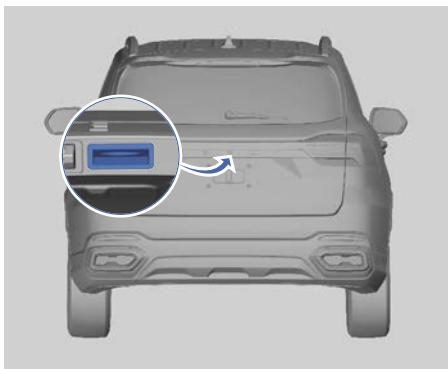
Когда автомобиль неподвижен, переключатель центрального замка в салоне автомобиля находится в состоянии «Разблокировано» и система противоугонной сигнализации отключена, нажмите наружный выключатель отпирания на двери багажного отделения, чтобы открыть ее.
