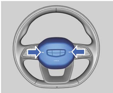
Нажмите на рулевое колесо в области кнопки звукового сигнала (показана стрелками на рисунке), чтобы включить звуковой сигнал.
