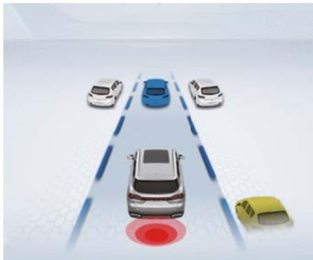
Функция предупреждения о наезде сзади работает на передаче P/N/D, и автомобиль не откатывается назад. Обнаруживаемые сзади цели:
