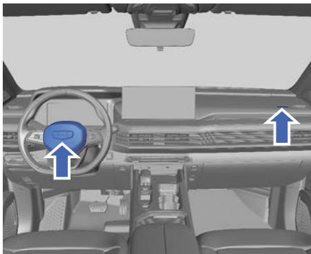
Передние подушки безопасности установлены по центру рулевого колеса и на приборной панели над перчаточным ящиком и обозначены надписями AIRBAG.
