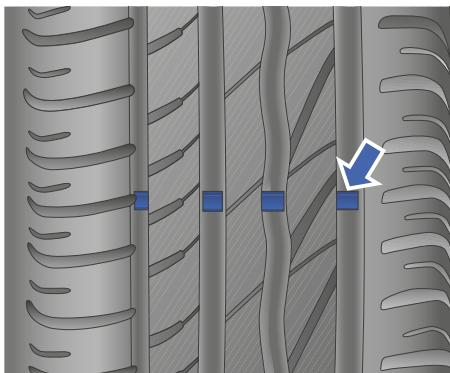
Индикатор износа становится видимым в том случае, если остаточная глубина протектора составляет 1,6 мм или менее. При достижении предельного износа шин как можно скорее замените шины.
