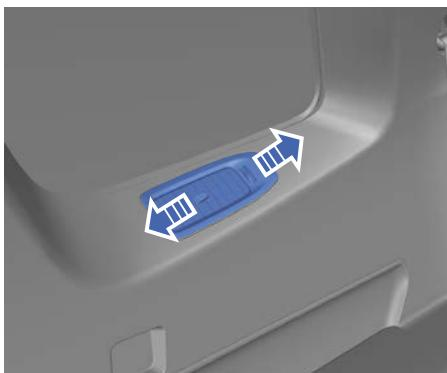
Переместите рычажок, чтобы отрегулировать направление воздушного потока или полностью перекрыть подачу воздуха.
