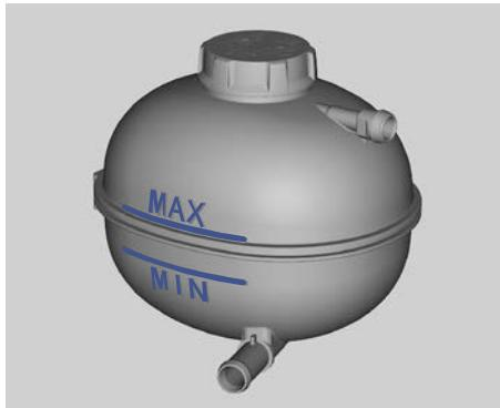
При проверке уровня охлаждающей жидкости двигателя автомобиль должен находиться на горизонтальной площадке. Убедитесь в том, что уровень охлаждающей жидкости в расширительном бачке находится между отметками MAX и MIN. Если уровень охлаждающей жидкости опустился ниже отметки MIN, долейте охлаждающую жидкость в расширительный бачок в соответствии с установленной процедурой.
