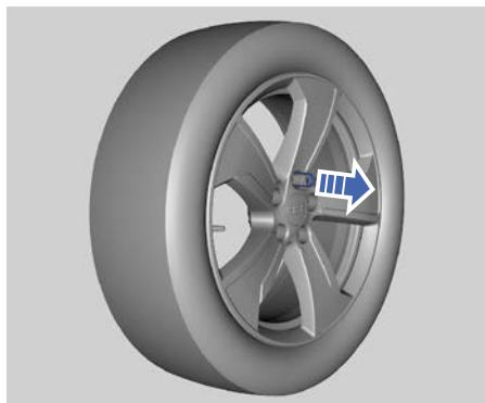
2. Достаньте пластмассовые щипцы из набора инструментов, зажмите ими колпачок колесной гайки, как показано на рисунке, и потяните колпачок наружу.
