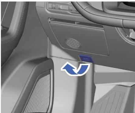
1. Потяните на себя рукоятку открывания замка капота, которая находится в левом нижнем углу приборной панели со стороны водителя.
