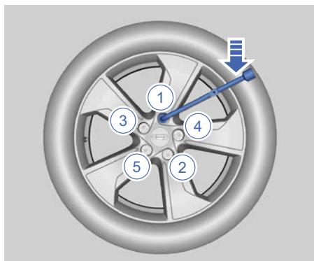
13. Затяните колесные гайки в перекрестном порядке, как показано на рисунке.
