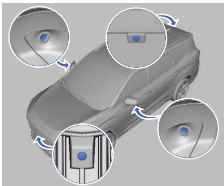
Камеры системы панорамного обзора расположены по периметру кузова автомобиля.
