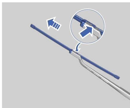
3. Удерживая нажатыми кнопки фиксатора, потяните щетку стеклоочистителя в направлении стрелки и высвободите ее из рычага стеклоочистителя.
