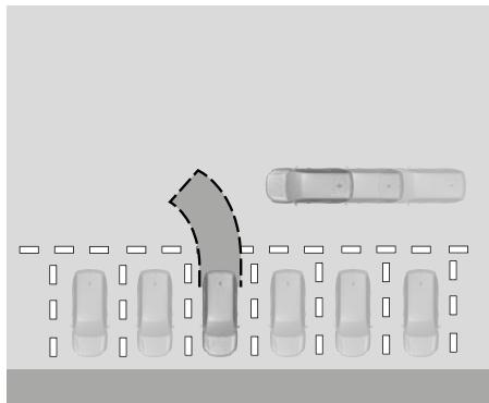
Система предупреждения об объектах, двигающихся в поперечном направлении сзади, использует задние боковые радары среднего диапазона для контроля приближающихся объектов. При обнаружении риска столкновения автомобиля с приближающимся сзади транспортным средством, мотоциклом, велосипедистом, пешеходом и т. д. система предупреждения об объектах, двигающихся в поперечном направлении сзади, выдает предупреждение для уведомления водителя об опасности.
