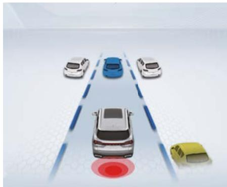
Функция предупреждения о наезде сзади работает на передаче Р/Н/Д, и автомобиль не откатывается назад. Обнаруживаемые сзади цели:
