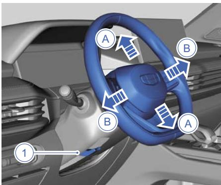
1. Рычаг блокировки рулевого колеса
