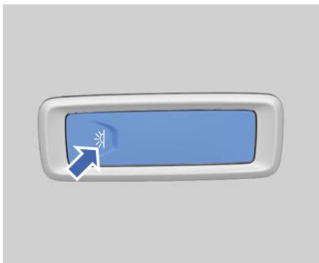
Чтобы включить или выключить потолочный плафон освещения заднего ряда сидений, нажмите выключатель плафона.
