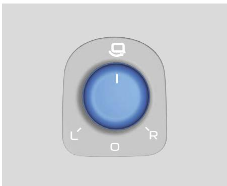
Пусковой переключатель должен находиться в режиме ACC или ON.
