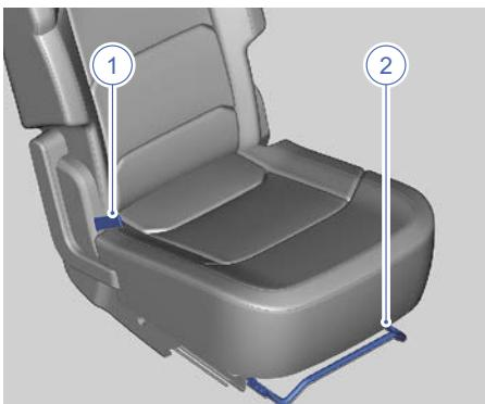
1. Лента регулировки угла наклона спинки сиденья
