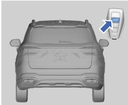
При выключенном зажигании нажмите и удерживайте кнопку отпирания двери багажного отделения на смарт-ключе, чтобы разблокировать дверь багажного отделения, а затем нажмите наружный выключатель отпирания на двери багажного отделения, чтобы открыть ее.
