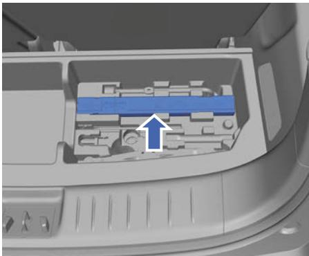
Знак аварийной остановки находится в вещевом ящике под панелью пола багажного отделения.
