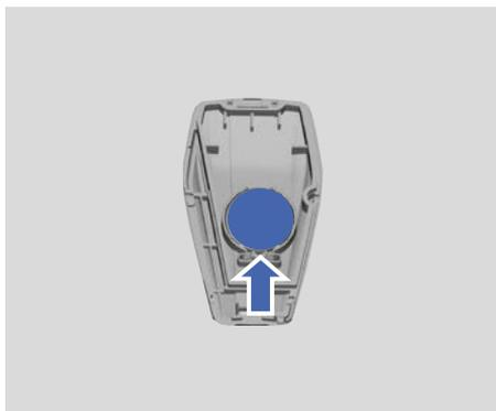
2. Открыв корпус смарт-ключа, замените элемент питания на новый. Обращайте внимание на полярность элемента питания при его установке (положительный контакт должен находиться сверху, см. рисунок).
