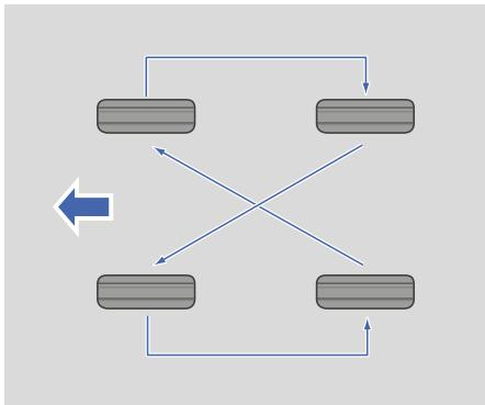
Выполняйте перестановку в указанной на рисунке последовательности при использовании шин с ненаправленным\* рисунком протектора. После перестановки колес отрегулируйте давление в передних и задних шинах до значений, указанных в соответствующей справочной табличке.
