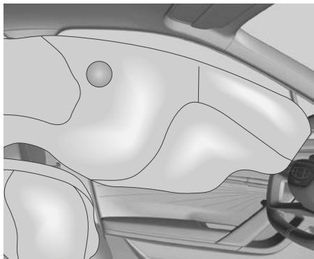
Боковые подушки безопасности и шторки безопасности (на некоторых моделях) срабатывают при умеренном или сильном боковом ударе, когда ударное воздействие превышает определенный пороговый уровень.
