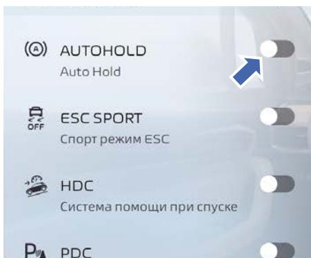
На мультимедийном дисплее нажмите Общие настройки автомобиля → Настройки автомобиля → Системы помощи при вождении. В этом интерфейсе включите или выключите функцию автоматического удержания автомобиля на месте (AUTO HOLD).
