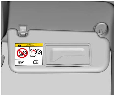
Наклейки с предупреждением о наличии в автомобиле передней подушки безопасности и необходимости соблюдения соответствующих мер предосторожности размещены на передней и задней поверхности солнцезащитного козырька со стороны пассажира.
