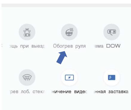
После запуска двигателя функцию обогрева рулевого колеса можно включить, нажав кнопку обогрева рулевого колеса в интерфейсе мультимедийной системы. Работа функции обогрева прекращается при достижении температуры примерно 40 °C. Функцию обогрева также можно отключить с помощью соответствующей кнопки.
