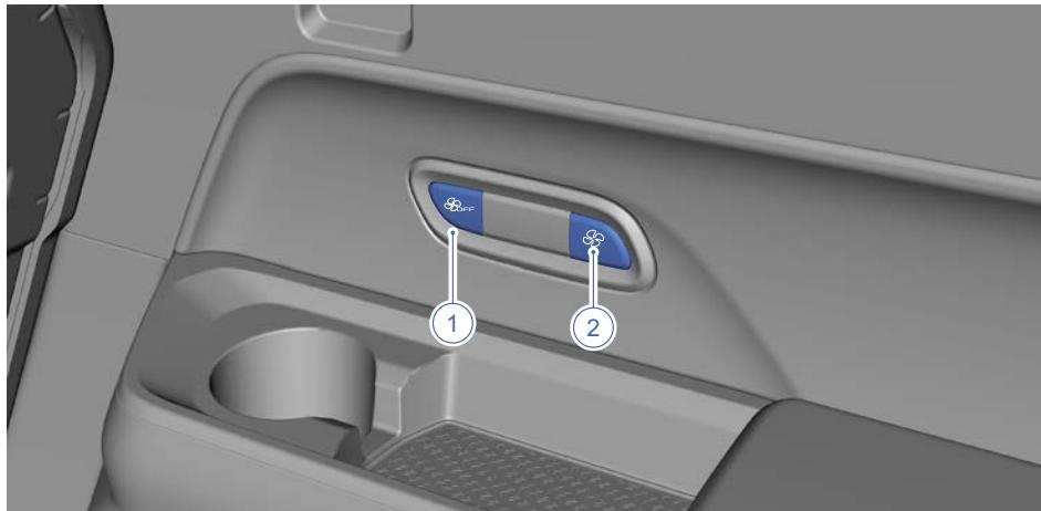
1. Кнопка регулировки скорости вентилятора / выключения
