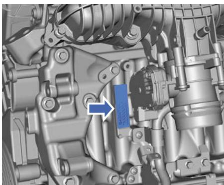
Номер двигателя выбит на блоке цилиндров за дроссельной заслонкой (номер виден с передней стороны автомобиля)\*.
