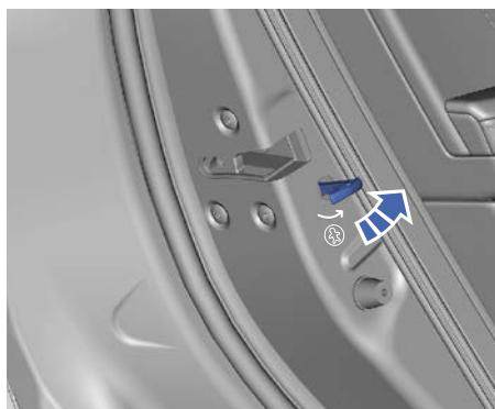
Левая и правая задние двери оснащены устройствами защиты от открывания детьми. Если на левом или правом заднем сиденье находится ребенок, следует задействовать предохранительные устройства. Переключатель предохранительного устройства расположен на внешнем крае задней двери. Переместите переключатель устройства защиты в направлении стрелки, как показано на рисунке. Предохранительное устройство будет переведено
