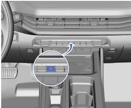
Если во время движения возникла экстренная ситуация, требующая снижения скорости или остановки автомобиля, нажмите выключатель аварийной сигнализации. Индикатор на выключателе начнет мигать. Одновременно будут мигать левые и правые указатели поворота для предупреждения других участников дорожного движения.
