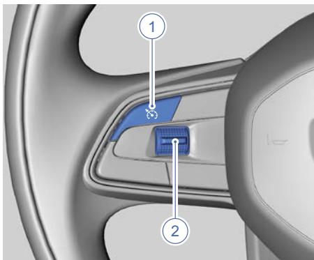
Кнопки управления круиз-контролем находятся на левой стороне рулевого колеса.
