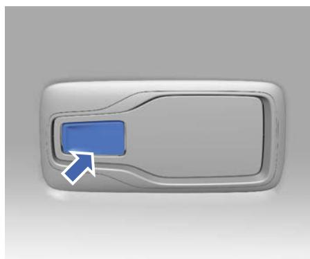
Нажмите выключатель левого или правого плафона освещения среднего ряда сидений, чтобы включить или выключить плафон освещения с соответствующей стороны.
