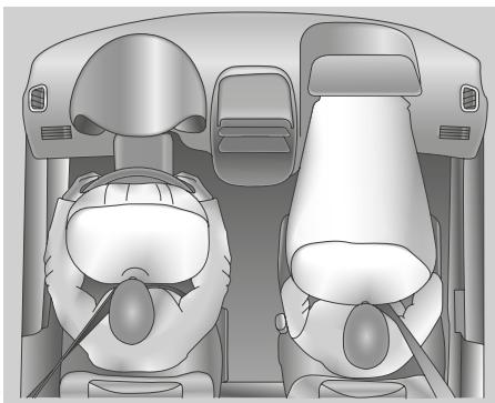
Срабатывание подушек безопасности зависит в большей степени от природы объекта, с которым произошло столкновение, интенсивности замедления автомобиля и направления удара, нежели от скорости движения автомобиля. В случае сильного фронтального удара раскрываются обе передние подушки безопасности.
