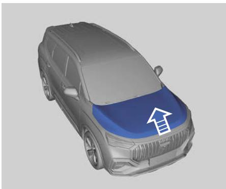
2. Потяните влево ручку крюка замка капота, расположенную по центру в просвете между решеткой радиатора и капотом.
