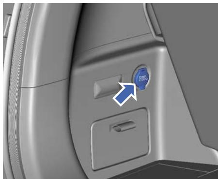
Электрическая розетка может использоваться для подключения электроприборов с максимальной потребляемой мощностью не более 120 Вт.
