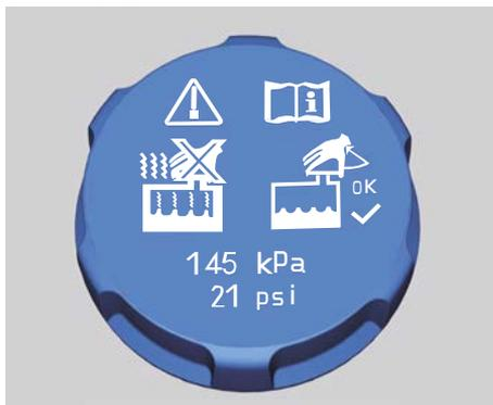
1. Медленно поверните крышку против часовой стрелки. Открывайте крышку только после того, как характерный
