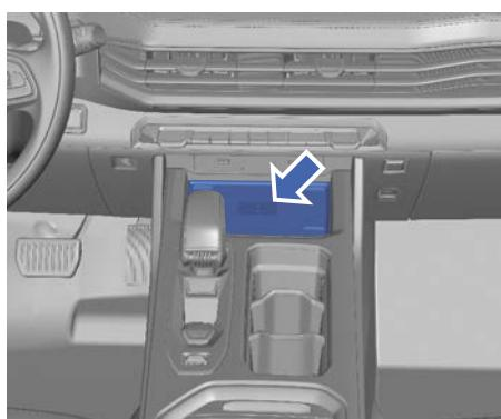
При использовании панели беспроводной зарядки следите, чтобы катушка мобильного телефона совпадала с катушкой в центре зарядной панели. Поскольку расположение катушки мобильного телефона зависит от модели телефона, может потребоваться регулировка положения мобильного телефона на зарядной панели.
