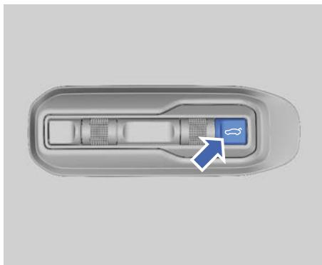
Когда автомобиль неподвижен и дверь багажного отделения открыта, а система противоугонной сигнализации отключена, нажмите и удерживайте кнопку отпирания двери багажного отделения на блоке переключателей приборной панели, чтобы закрыть дверь багажного отделения.
