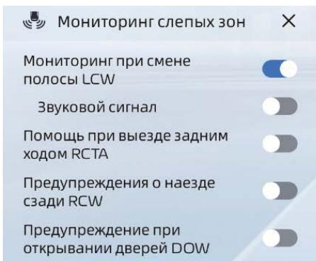
На мультимедийном дисплее нажмите: Общие настройки автомобиля → Помощь при вождении → Мониторинг слепых зон. Включите или выключите нужную функцию в данном интерфейсе. Включенное/выключенное состояние всех функций сохраняется в памяти.
