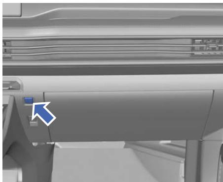
Выключатель открывания крышки перчаточного ящика находится с левой стороны перчаточного ящика. Чтобы открыть перчаточный ящик, нажмите выключатель. Для закрывания перчаточного ящика нажмите на его крышку.
