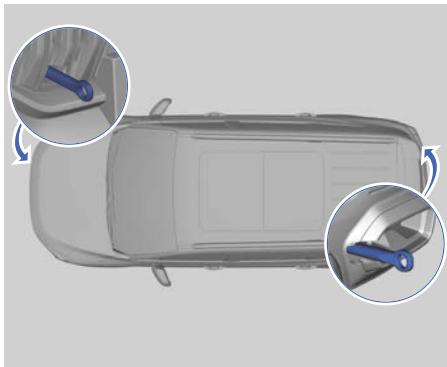
3. Вверните буксировочную проушину в монтажное отверстие и затяните ее, вставив в проушину «баллонный» ключ. Убедитесь в том, что проушина надежно затянута.
