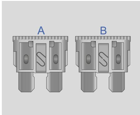
А – исправный предохранитель
