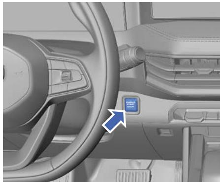
Автомобиль оснащен пусковым переключателем, который позволяет запускать двигатель нажатием кнопки. Для управления системой необходимо, чтобы смарт-ключ находился в автомобиле и распознавался системой. Пусковой переключатель имеет следующие режимы:
