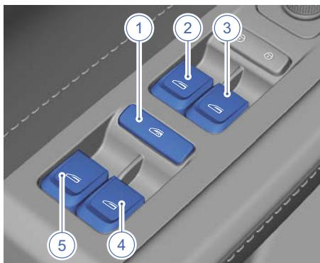
1. Выключатель блокировки стеклоподъемников
