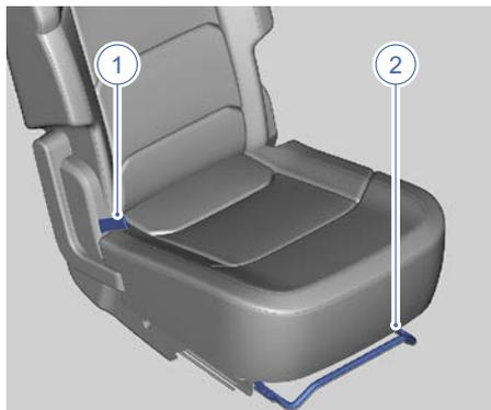
1. Лента регулировки угла наклона спинки сиденья
