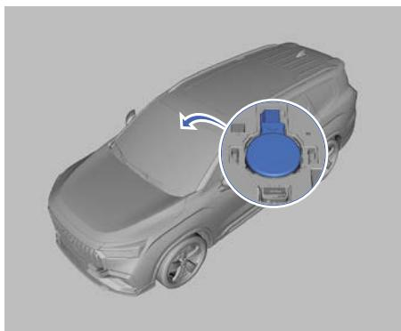
Датчик наружной освещенности и солнечного излучения, установленный за ветровым стеклом, передает измеренную интенсивность солнечного излучения, а система кондиционирования воздуха на основании этого сигнала регулирует температуру в салоне автомобиля. При
