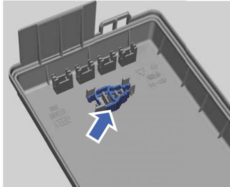
2. Зажмите верхнюю часть предохранителя съемными щипцами для предохранителей и извлеките его. Проверьте, не перегорела ли металлическая проволока в предохранителе.
