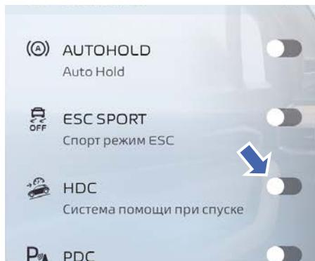
На мультимедийном дисплее нажмите: Общие настройки автомобиля → Настройки автомобиля → Системы помощи при вождении, а затем включите или выключите функцию контроля движения под уклон (HDC) в этом интерфейсе.
