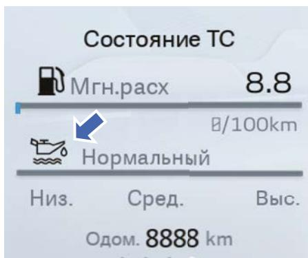
1. При включенном зажигании можно проверить уровень моторного масла на комбинации приборов. Когда на комбинации приборов отображается низкий уровень моторного масла, необходимо своевременно произвести долив.
