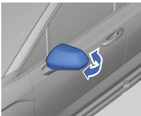
Рукой поверните наружное зеркало назад в сторону кузова автомобиля, чтобы сложить его.
