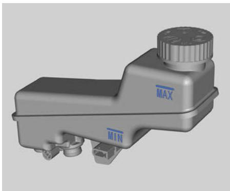
Периодически проверяйте уровень тормозной жидкости и следите за тем, чтобы он всегда находился между отметками MAX и MIN.
