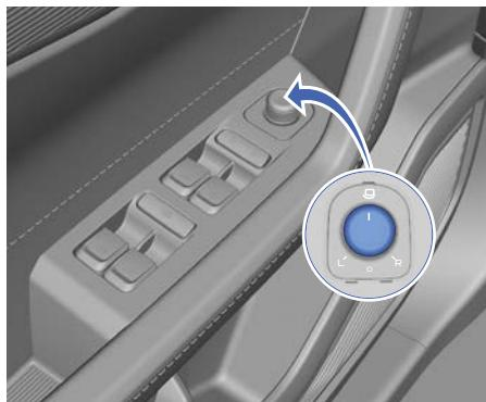
Переключатель регулировки наружных зеркал заднего вида располагается на внутренней декоративной накладке водительской двери.
