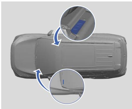
Номер VIN выбит на поперечине под передним пассажирским сиденьем. Чтобы увидеть номер, сдвиньте сиденье назад до упора и поднимите защитную крышку. Номер VIN находится на кронштейне кузова в левом нижнем углу лобового стекла и виден через лобовое стекло.
