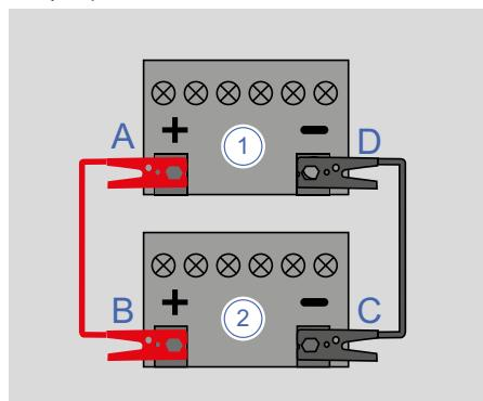
А: подсоедините один конец красного положительного кабеля к положительному (+) выводу (A) разряженной аккумуляторной батареи 1.
