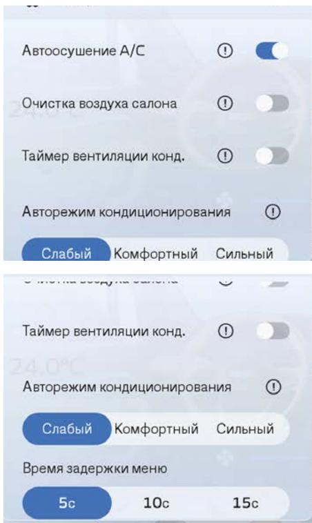
На мультимедийном дисплее нажмите: Кондиционер → Настройки кондиционера. В этом интерфейсе можно активировать или деактивировать функцию автоматического осушения кондиционера, функцию автоматической очистки воздуха в салоне, таймер вентиляции системы кондиционирования, автоматический режим кондиционирования и задать время задержки интерфейса системы кондиционирования.
